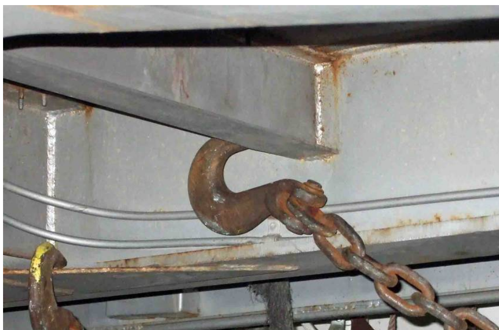
写真8 シャーシの車体裏の部材にかけた 固縛用チェーン
