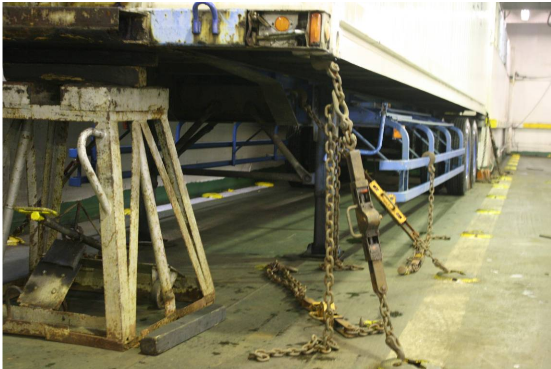
写真5 シャーシの固縛状態（6点取り）
