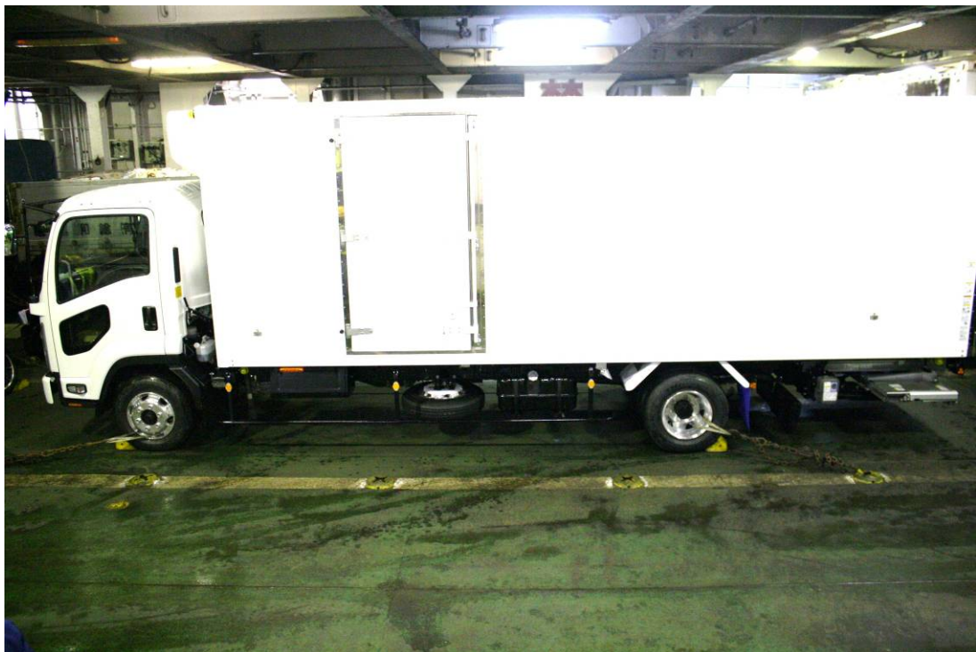
写真6 トラックの固縛状態
