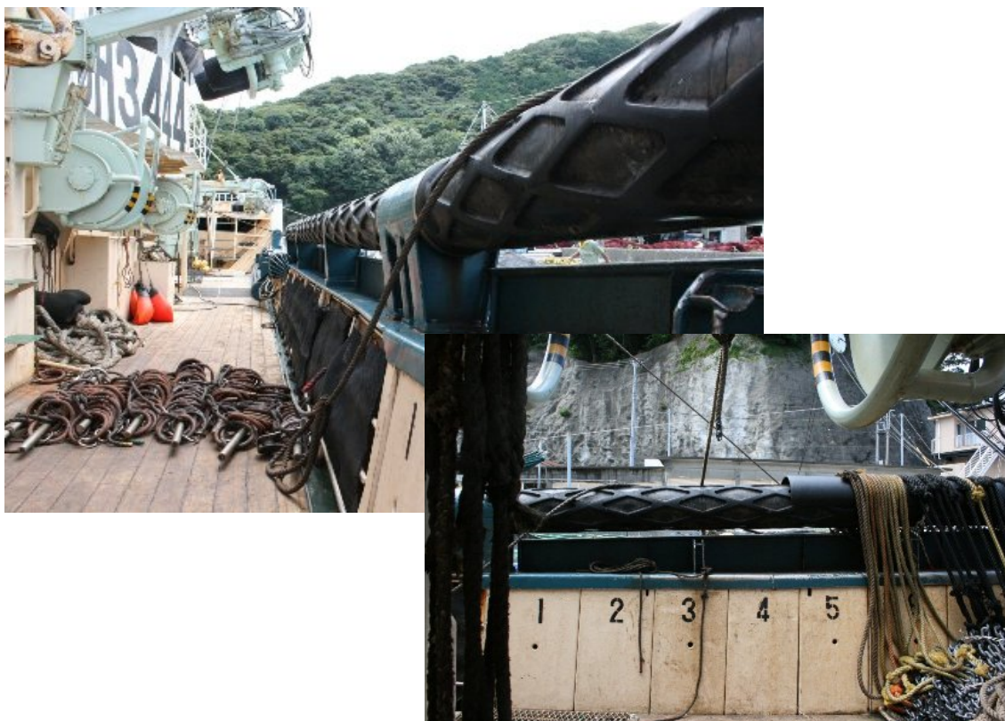
写真4 揚網用サイドローラー (類似船)
