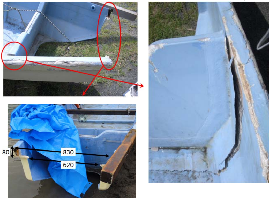
付図3 本船の主な損傷箇所（船尾部）
