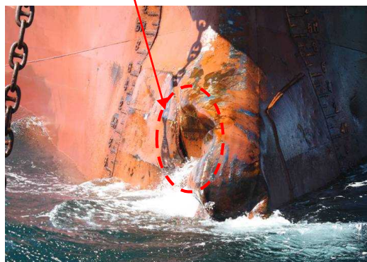
写真2.3-3 球状船首の損傷状況
