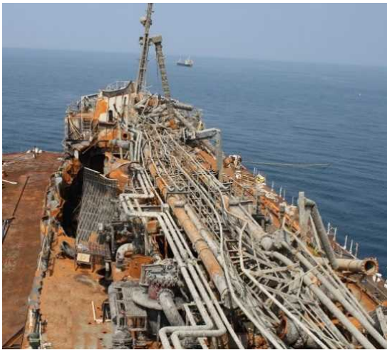
写真 2. 3 - 1 上甲板等の損傷状況
