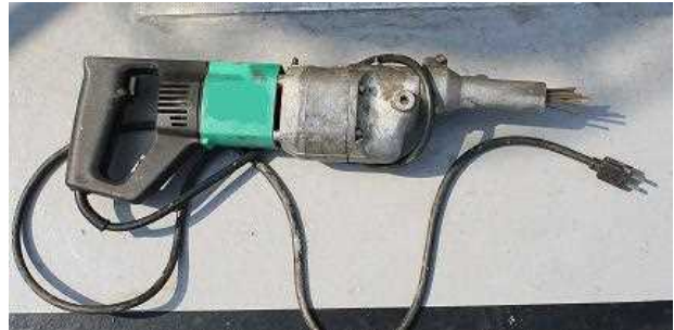
写真2.1-4 電動式多針たがね （本船使用の類似品）
