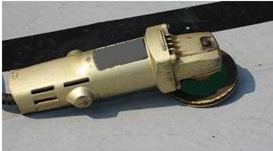
写真2.1-3 電動式ディスクグラインダ （本船使用の類似品）
